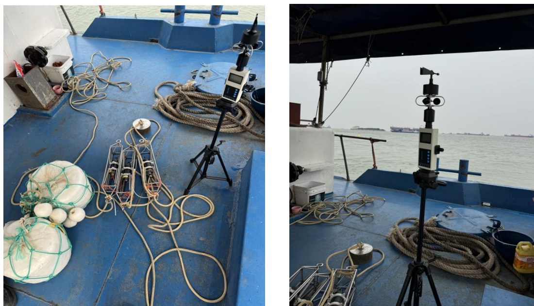
图 3，监测系统设备（左侧为水下录音系统，右侧为实时风速监测设备）
